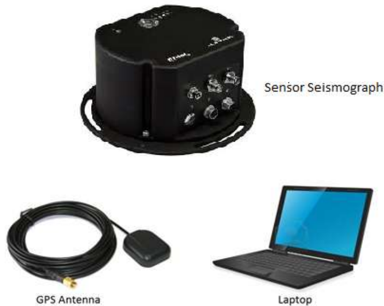
Gambar 3-3. Peralatan Survei dan Analisis Data Mikrotremor
