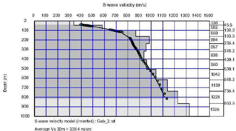
Gambar 4-11. Profil kecepatan gelombang geser (Vs) pada SPAC 03.
